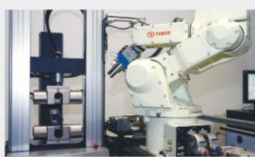
全自动电子拉伸试验机
